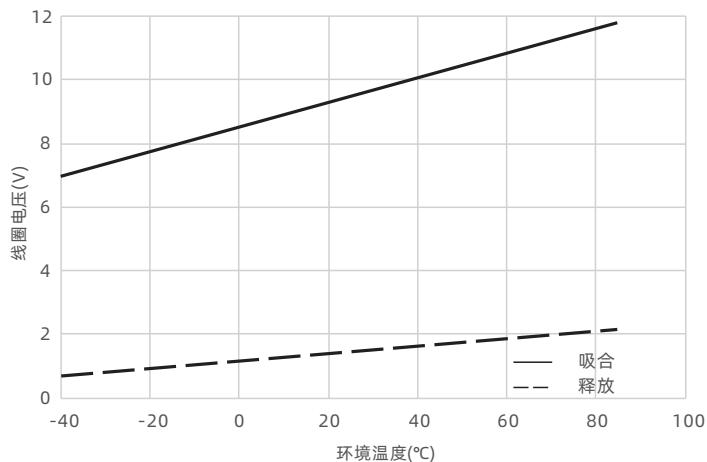
1)线圈供电电压 12VDC。
