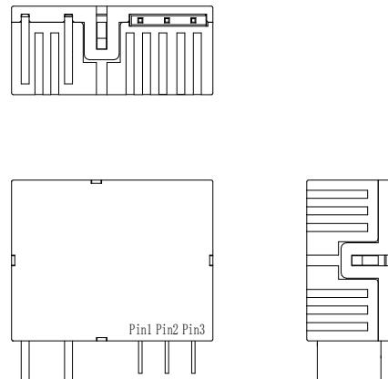
未标注尺寸公差: 尺寸  $< 1\text{ mm}$ , 公差:  $\pm 0.2\text{mm}$ ; 尺寸  $1\text{~}5\text{mm}$ , 公差:  $\pm 0.3\text{mm}$ ; 尺寸  $> 5\text{mm}$ , 公差:  $\pm 0.4\text{mm}$ 。
