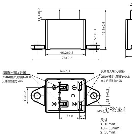
1) 允许最大图示扭矩安装，仅允许一次性安装，不允许反复拧紧螺钉；
