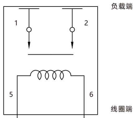
备注:负载端无极性,线圈端子无极性
