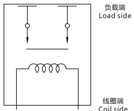
备注:负载端,线圈端子均无极性
